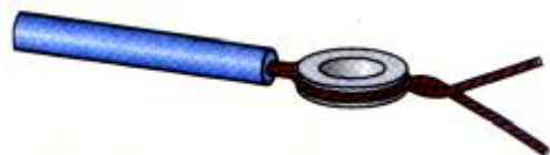
Rys. 32. Przewód wielodrutowy z oczkiem [1, s. 48]
