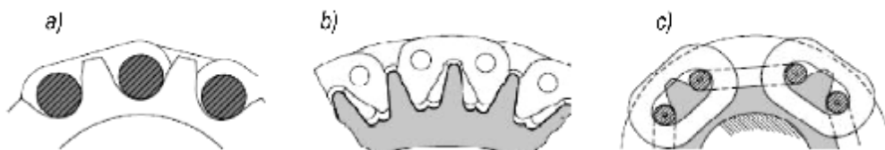
Rys. 15. Przekładnia łańcuchowa z różnymi typami łańcuchów [4, www]: a) drabinkowym, b) zębatym, c) pierścieniowym
