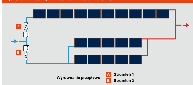
Rys. C.1.2-2 Instalacja z wieloma polami (pola nierówne)
