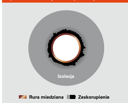
Rys. B.3.2-4 Izolacja ze strefą zeskorupienia
