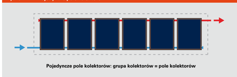
Rys. C.1.1-1 Pojedyncze pole kolektorów
