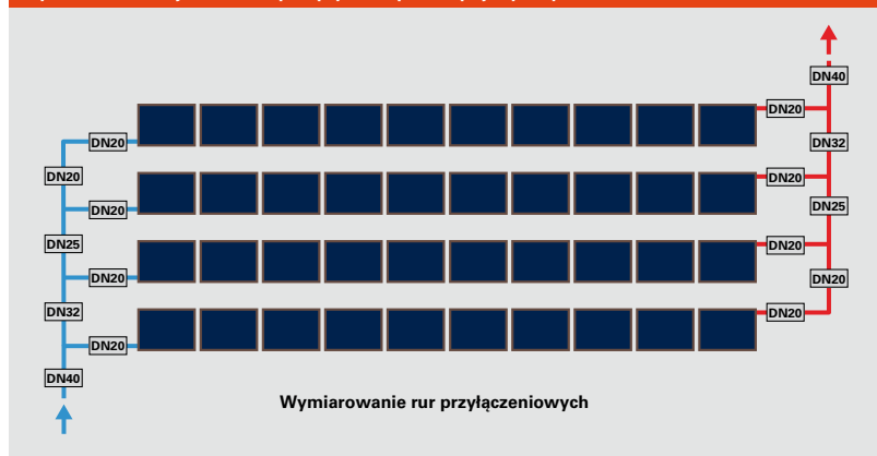
Rys. C.1.2-6 Projektowanie przepływu w polach pojedynczych
