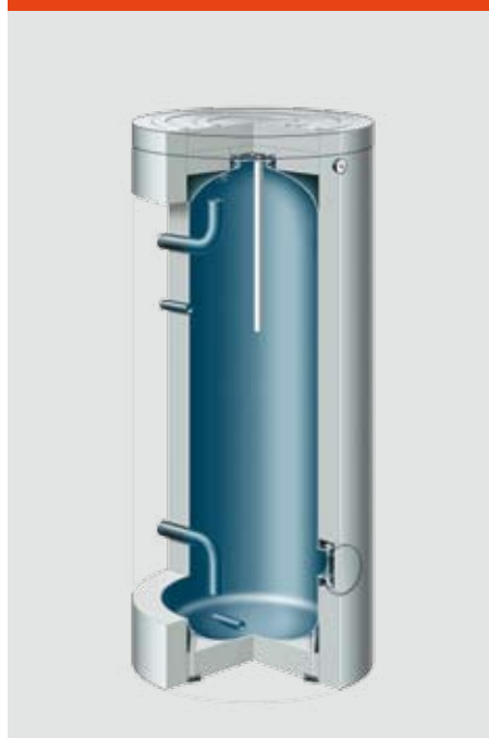
Rys. B.2.3-7 Zbiornik ładowany warstwowo do c.w.u.
