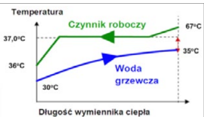
4 Poddany skropleniu czynnik w skraplaczu przekazuje ciepło do wody grzewczej
