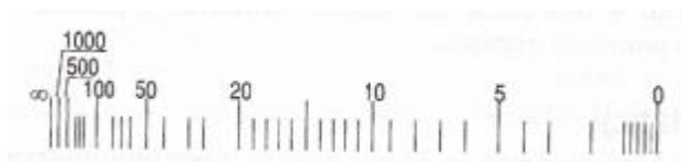
Rys.18. Podziałka omomierza szeregowego [9, s.41]
