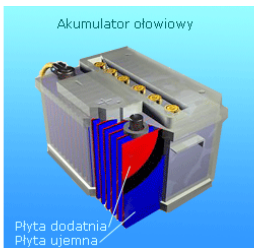
Rys. 28. Model akumulatora ołowiowego [ www.elektroda.net/nauka/ ]
