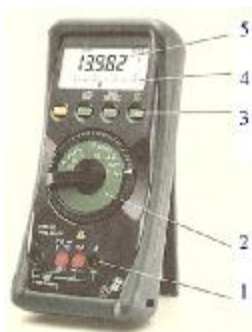
Rys. 8. Multimetr cyfrowy: 1 – wejścia, 2 – pokrętko wyboru wielkości mierzonej (funkcji), 3 – przyciski automatycznego lub ręcznego wyboru zakresu, włączania zapamiętywania wyniku, 4 – wskaźnik analogowy, 5 – wyświetlacz. [3]
