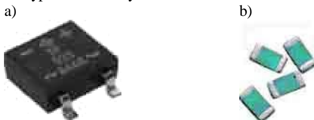
Rys. 49. Widok typowych elementów SMD: a) mostek prostowniczy, b) rezystory [9]
