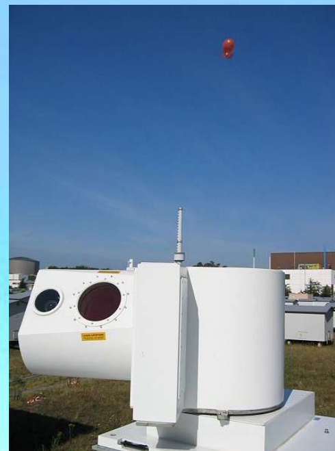
Lidar dopplerowski "WindTracer"
