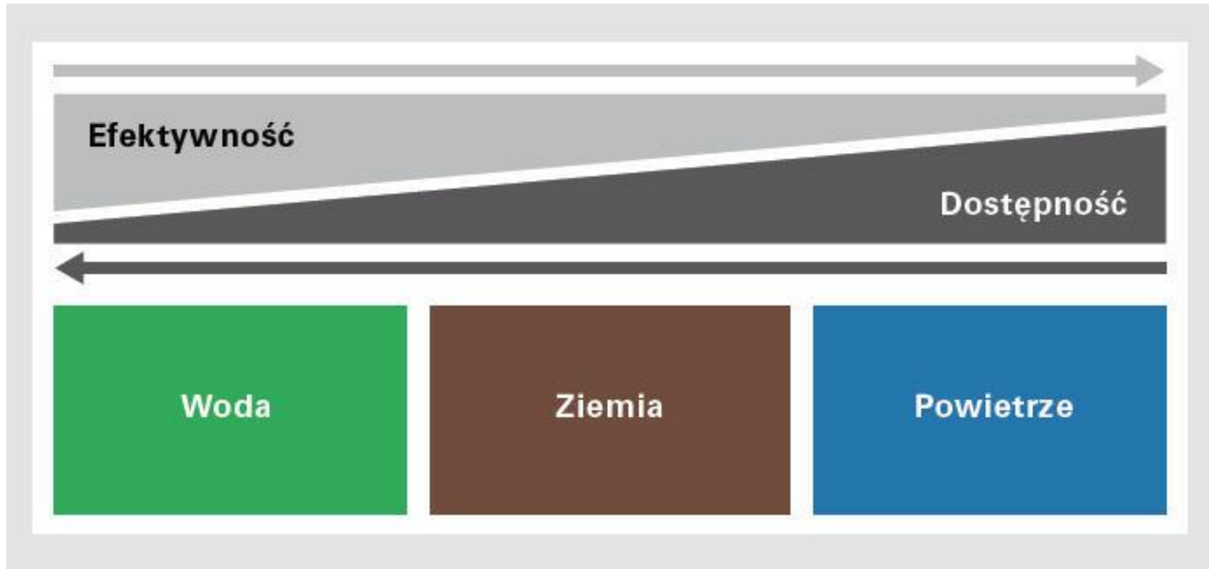
Rys. Efektywność PC w zależności od źródła ciepła i jego dostępność.
