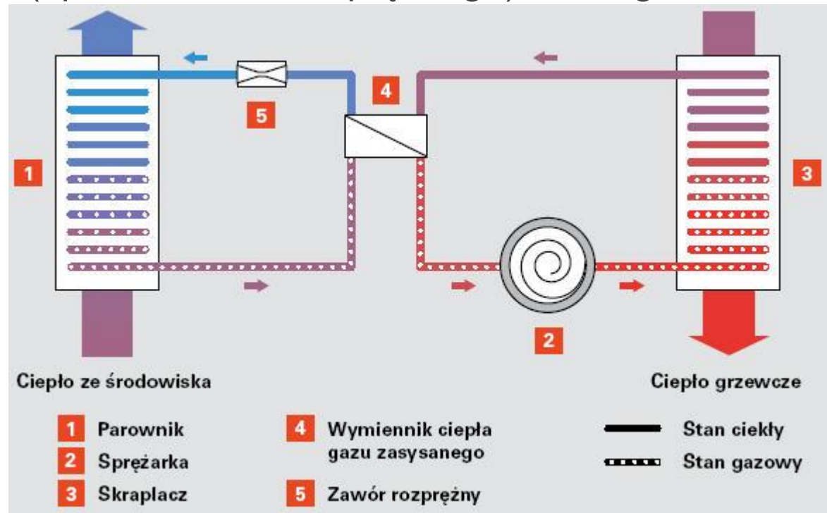
Rys. Schemat obiegu PC z wymiennikiem ciepła gazu zasysanego
