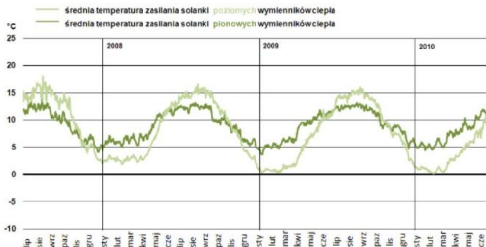
Rys. Średnie dzienne temperatury zasilania solanki dla instalacji z poziomymi i pionowymi wymiennikami gruntowymi.
