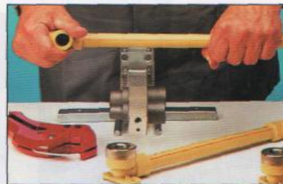
8 Łączenie elementów rurowych
