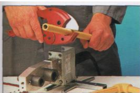
5 Przycięcie i gratowanie rury
