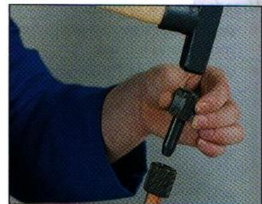
4 Kalibracja pierścieniem kalibrującym oraz trzpieniem
