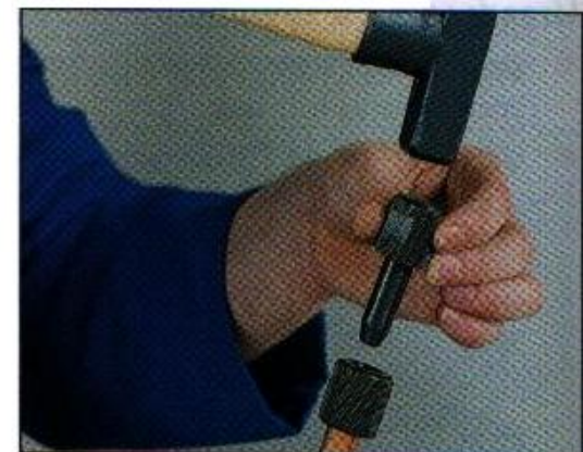
4 Kalibracja pierścieniem kalibrującym oraz trzpieniem
