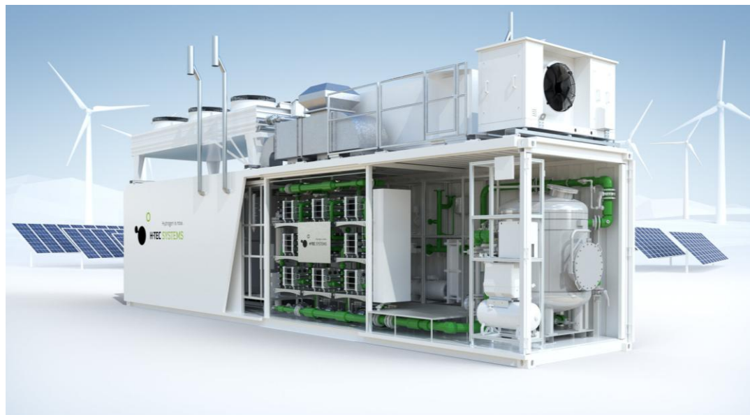
H-TEC 1 MW – 1 kontener 40' (12,2 x 2,4 x 2,6 m) 450 kg H 2 / 24h (210 Nm 3 /h) PEM
